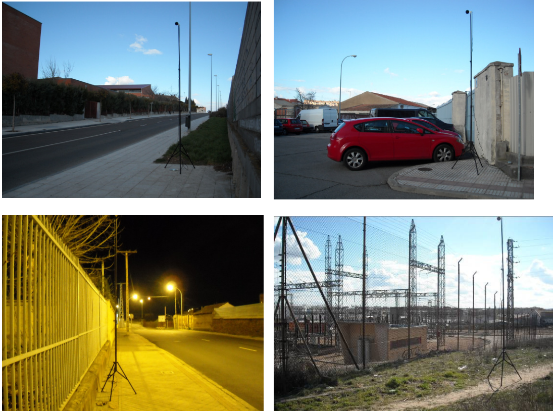
Ilustración 3. Proceso de registro de niveles sonoros.
