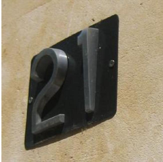
2.4.2. Guarismos o números: Serán de aluminio inyectado, de dimensiones 130x60 mm., posición inclinada con saliente de 20 mm en la parte superior y de 8 mm en la parte inferior, de acuerdo a modelo de la fotografía adjunta. En la parte posterior se fijan a la placa mediante tornillos de acero inoxidable incluidos.
