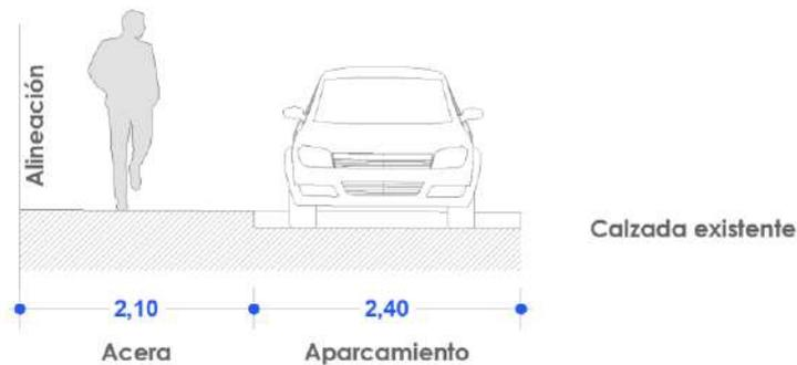
Los bordillos tendrán la altura necesaria para no ser montables por los vehículos ligeros. Para ello se establece una altura mínima de 14 cm, no recomendándose alturas superiores a los 16 cm. Se recomienda una altura de 14 cm, con un mínimo absoluto de 10 cm.
