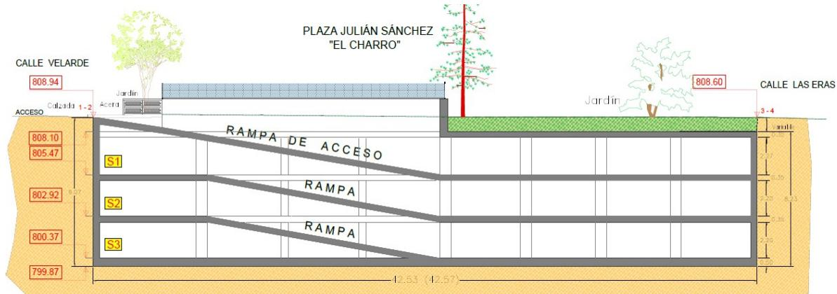
*De dicho prisma salen a la superficie de la Plaza dos rampas de acceso y salida de 84 y 120 m<sup>2</sup> respectivamente y conductos de ventilación y acceso peatonal de 13,4 y 4 m<sup>2</sup>.*
